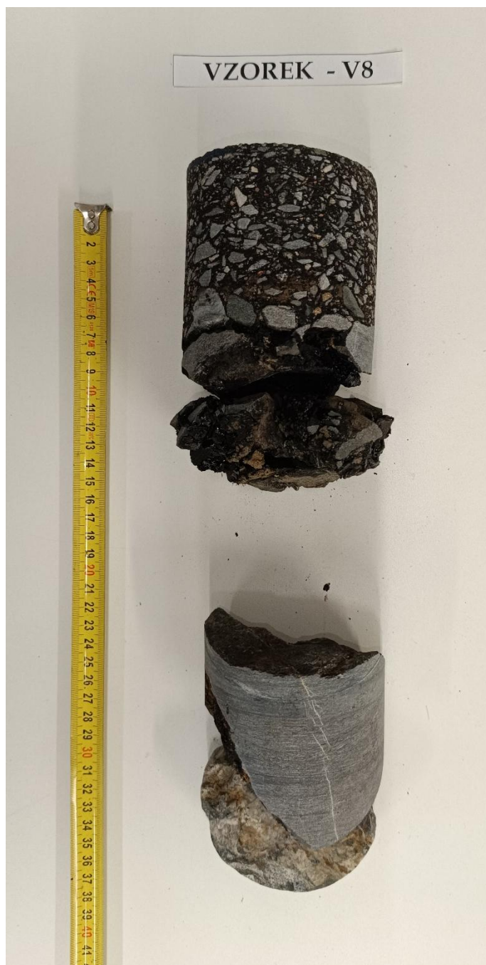
Obr. 16 - Jádru vývrtu Vzorek – V8 (laboratoř).
