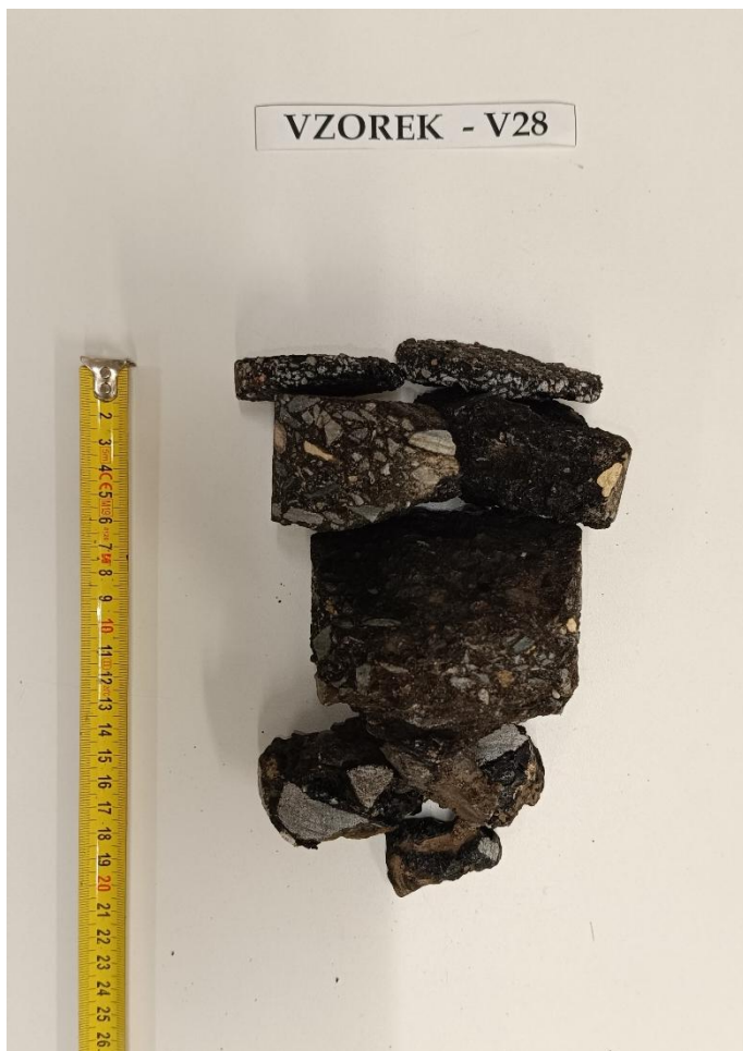
Obr. 56 - Jádru vývrtu Vzorek – V28 (laboratoř).
