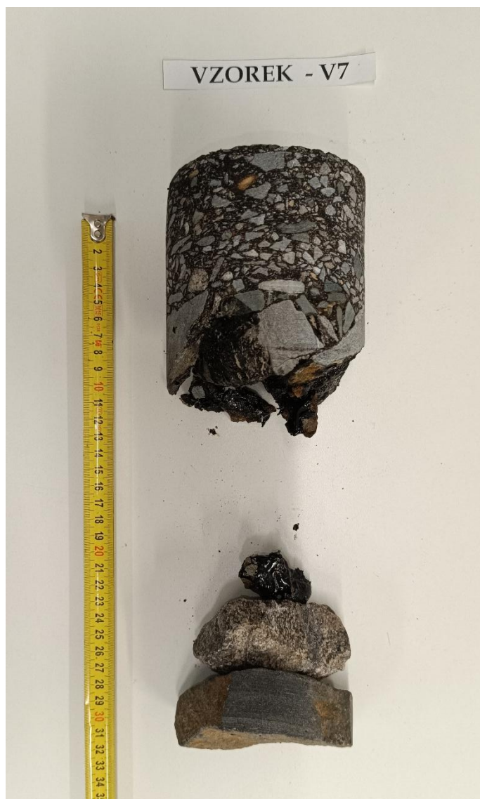
Obr. 14 - Jádro vývrtu Vzorek – V7 (laboratoř).
