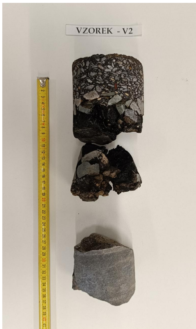
Obr. 4 - Jádru vývrtu Vzorek – V2 (laboratoř).
