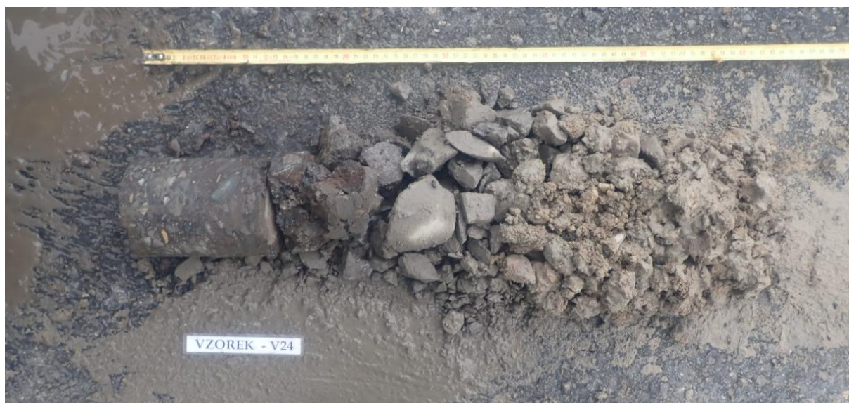
Obr. 47 - Jádro vývrtu Vzorek – V24 (in situ).
