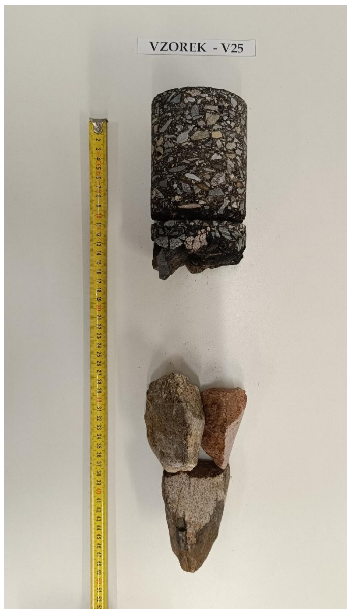
Obr. 50 - Jádru vývrtu Vzorek – V25 (laboratoř).
