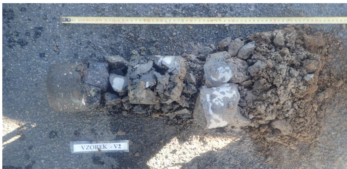
Obr. 3 - Jádro vývrtu Vzorek – V2 (in situ).
