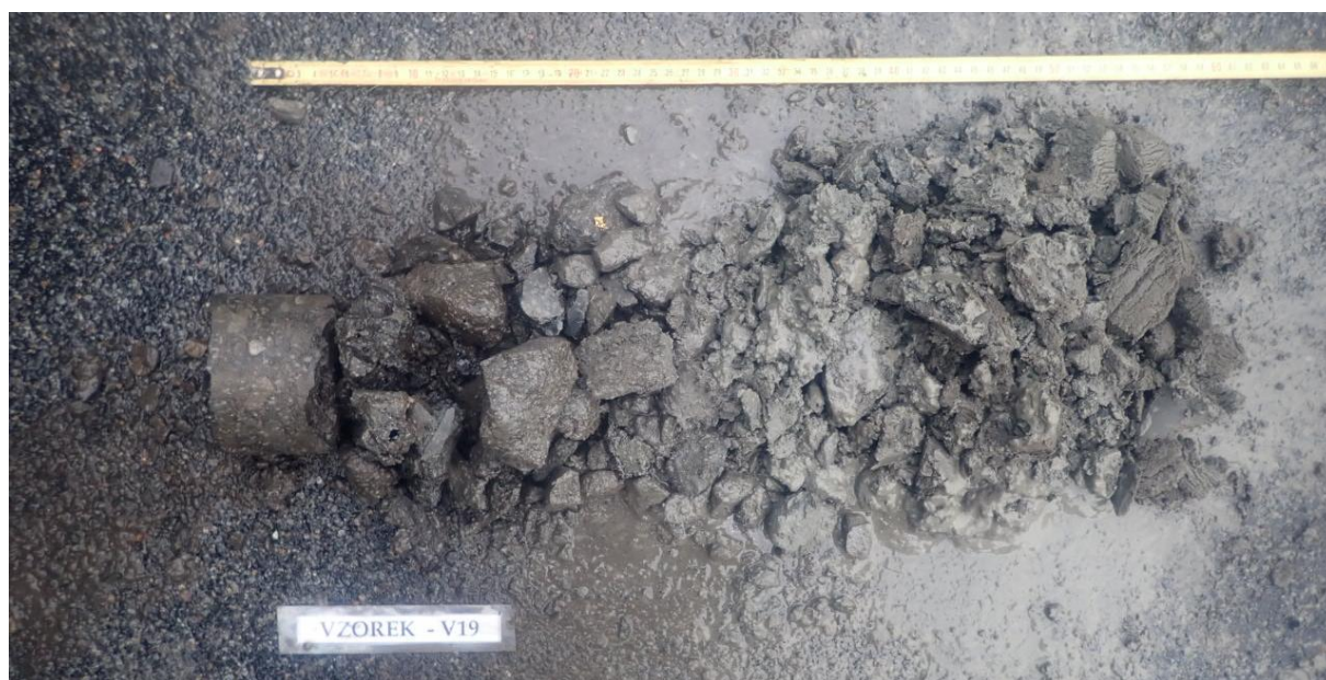
Obr. 37 - Jádru vývrtu Vzorek – V19 (in situ).
