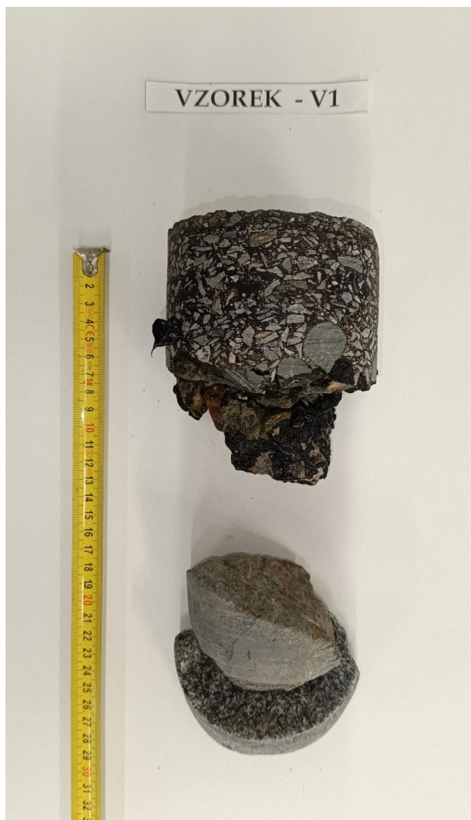
Obr. 2 - Jádru vývrtu Vzorek – V1 (laboratoř).
