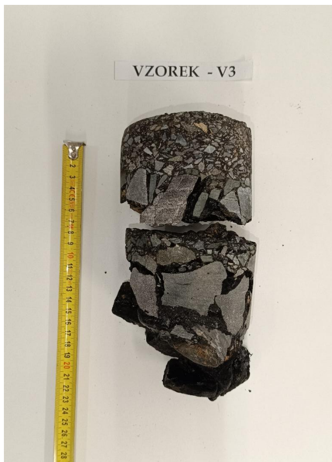
Obr. 6 - Jádru vývrtní vzorek – V3 (laboratorní).
