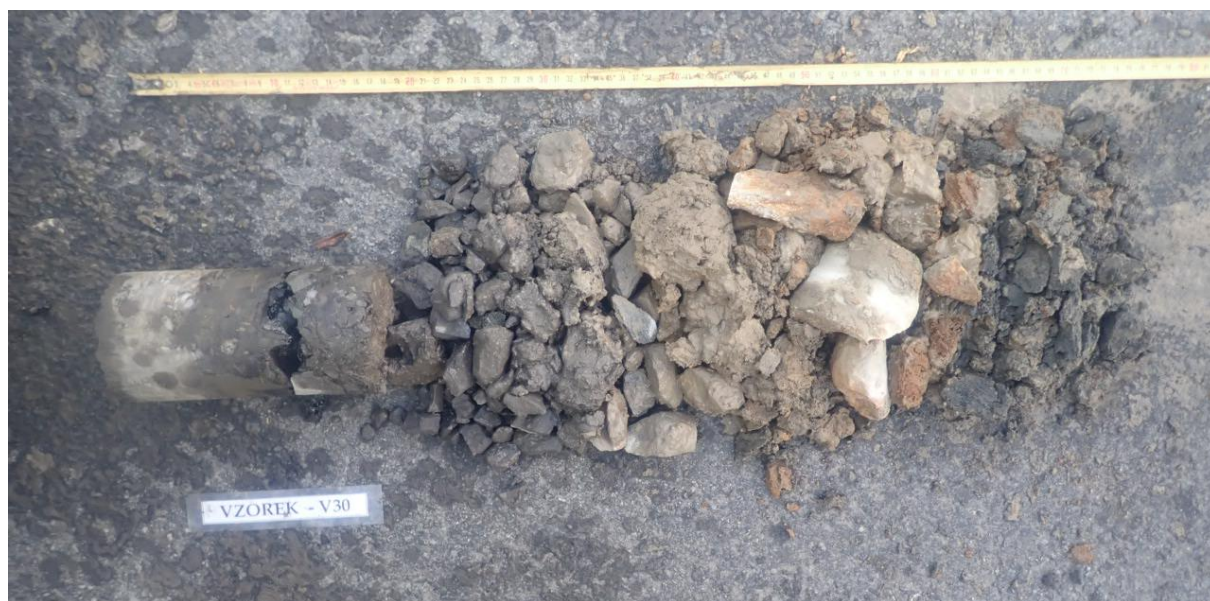
Obr. 59 - Jádro vývrtu Vzorek – V30 (in situ).
