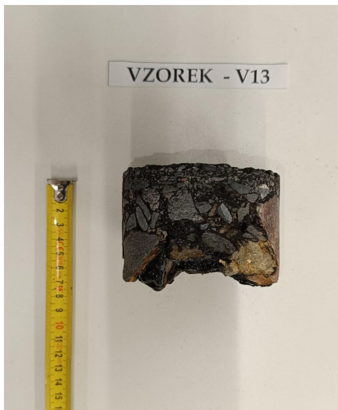
Obr. 26 - Jádru vývrtu Vzorek – V13 (laboratoř).
