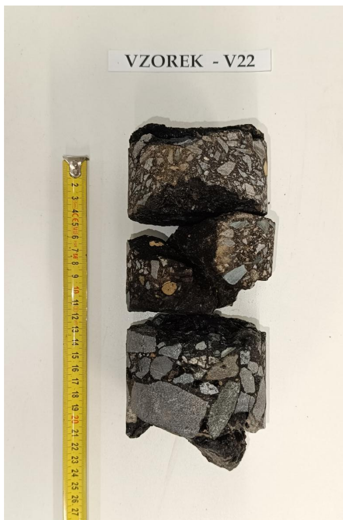
Obr. 44 - Jádru vývrtu Vzorek – V22 (laboratoř).
