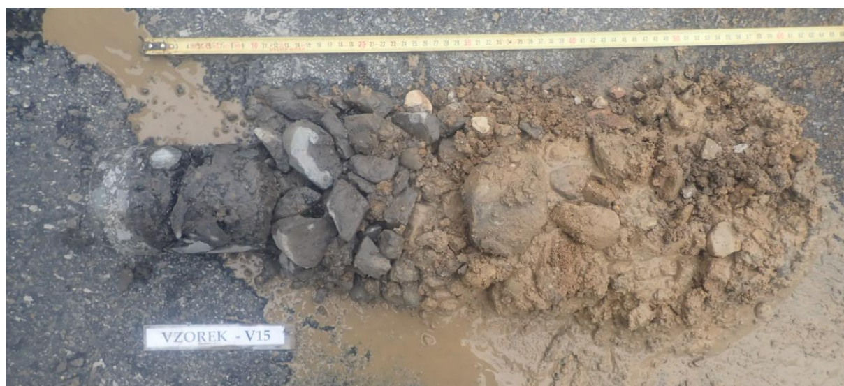
Obr. 29 - Jádro vývrtu Vzorek – V15 (in situ).
