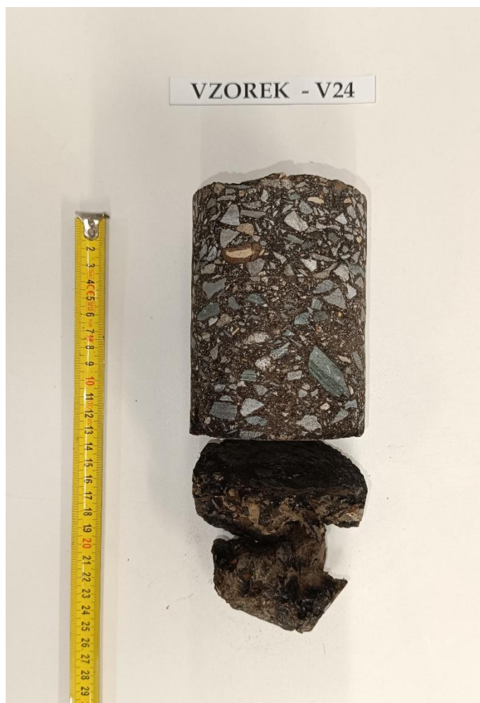
Obr. 48 - Jádru vývrtu Vzorek – V24 (laboratoř).
