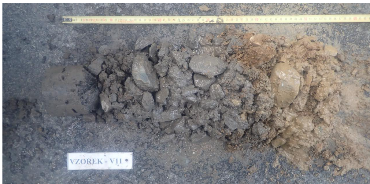
Obr. 21 - Jádru vývrtu Vzorek – V11 (in situ).
