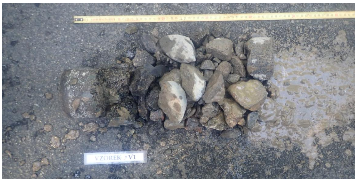
Obr. 1 - Jádro vývrtu Vzorek – V1 (in situ).
